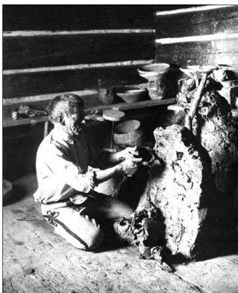
Przygotowanie surowca, struganie gliny skoblicą.
